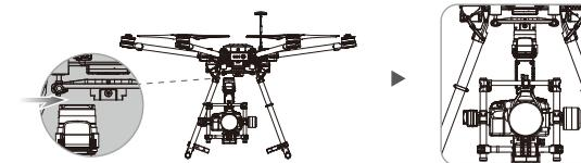
Проверьте правильно ли установлен и надежно ли закреплен Ronin-MX. Также убедитесь, что соединения выполнены должным образом и не препятствуют движениям Ronin-MX.
