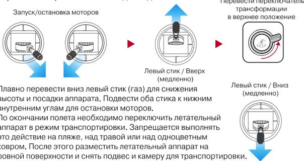
Плавное перевести вниз левый стик (газ) для снижения высоты и посадки аппарата. Подвести оба стика к нижним внутренним углам для остановки моторов. По окончании полета необходимо переключить летательный аппарат в режим транспортировки. Запрещается выполнять это действие на пляже, над травой или над одноцветным ковром. После этого разместить летательный аппарат на ровной поверхности и снять подвес и камеру для транспортировки.
